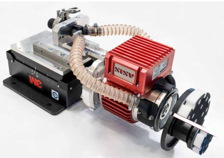
Abb. 20: ASIS Rob-E-Unit mit aktivem Kraftregelgerät.
