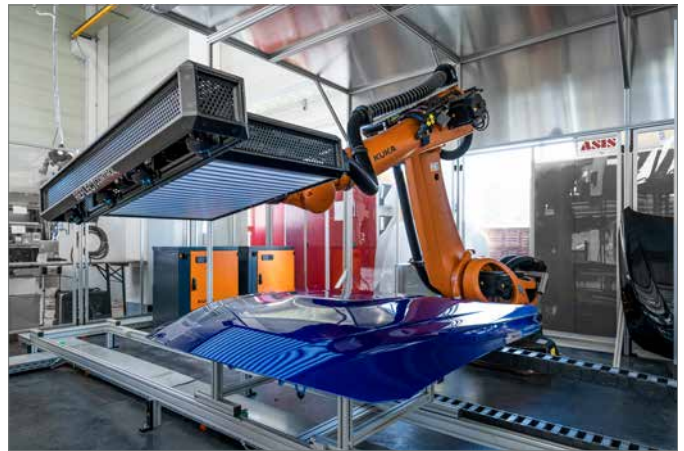
Abb. 2: Automatische Fehlerinspektion auf Klarlackoberflächen
