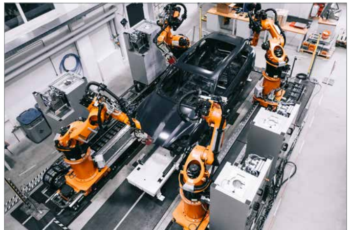
Abb. 3: Anlage für automatischen Füllerschleif im Voraufbau
