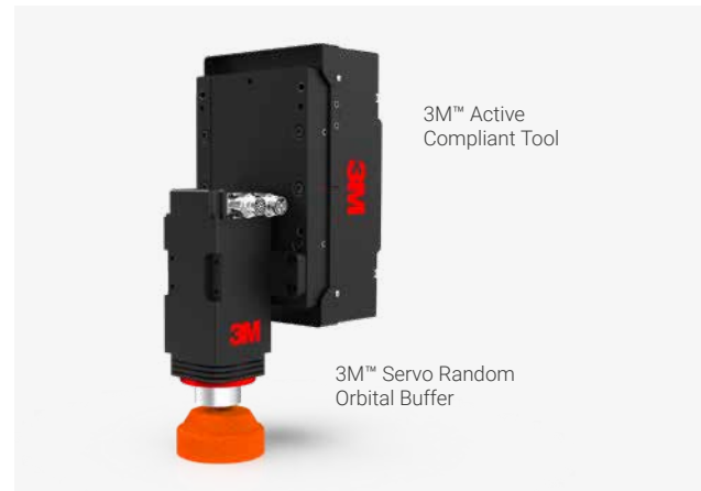
Abb. 27: 3M™ Polierapplikator mit aktivem Kontaktflansch
