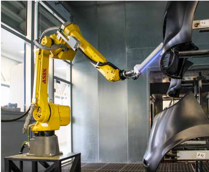
Abb. 2: Roboter gesteuertes Beflammen dreidimensionaler Kunststoffteile
