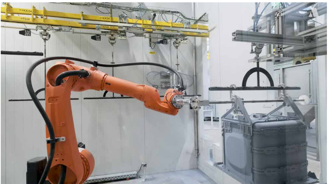
Abb. 13: Einfaches Handhabungsgerät zum Umhängen von Bauteilen
