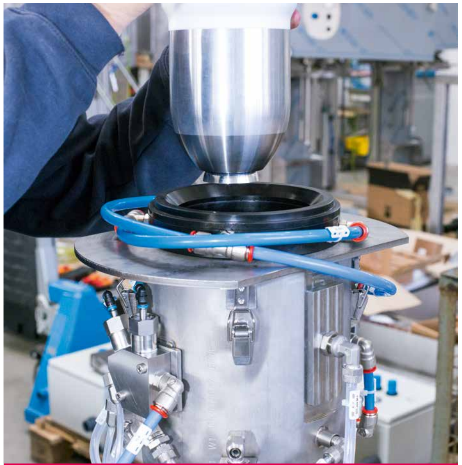
Reinigung von Hochrotationszerstäubern
