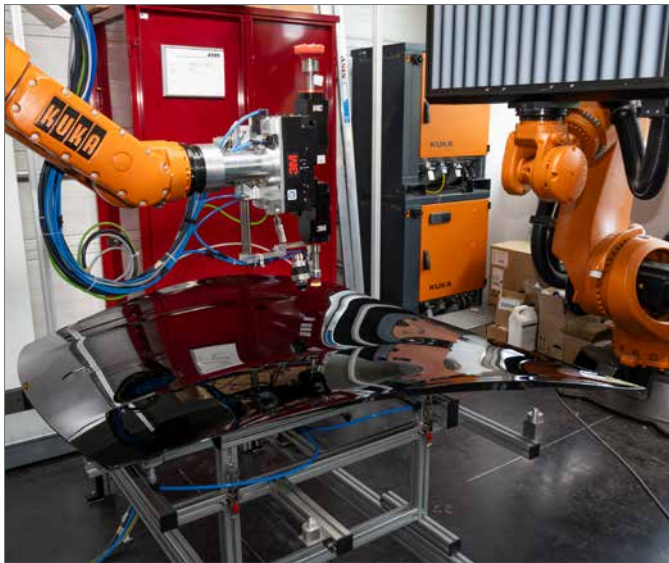
Voll ausgestattete Finish-Versuchszelle mit Fehlererkennung
