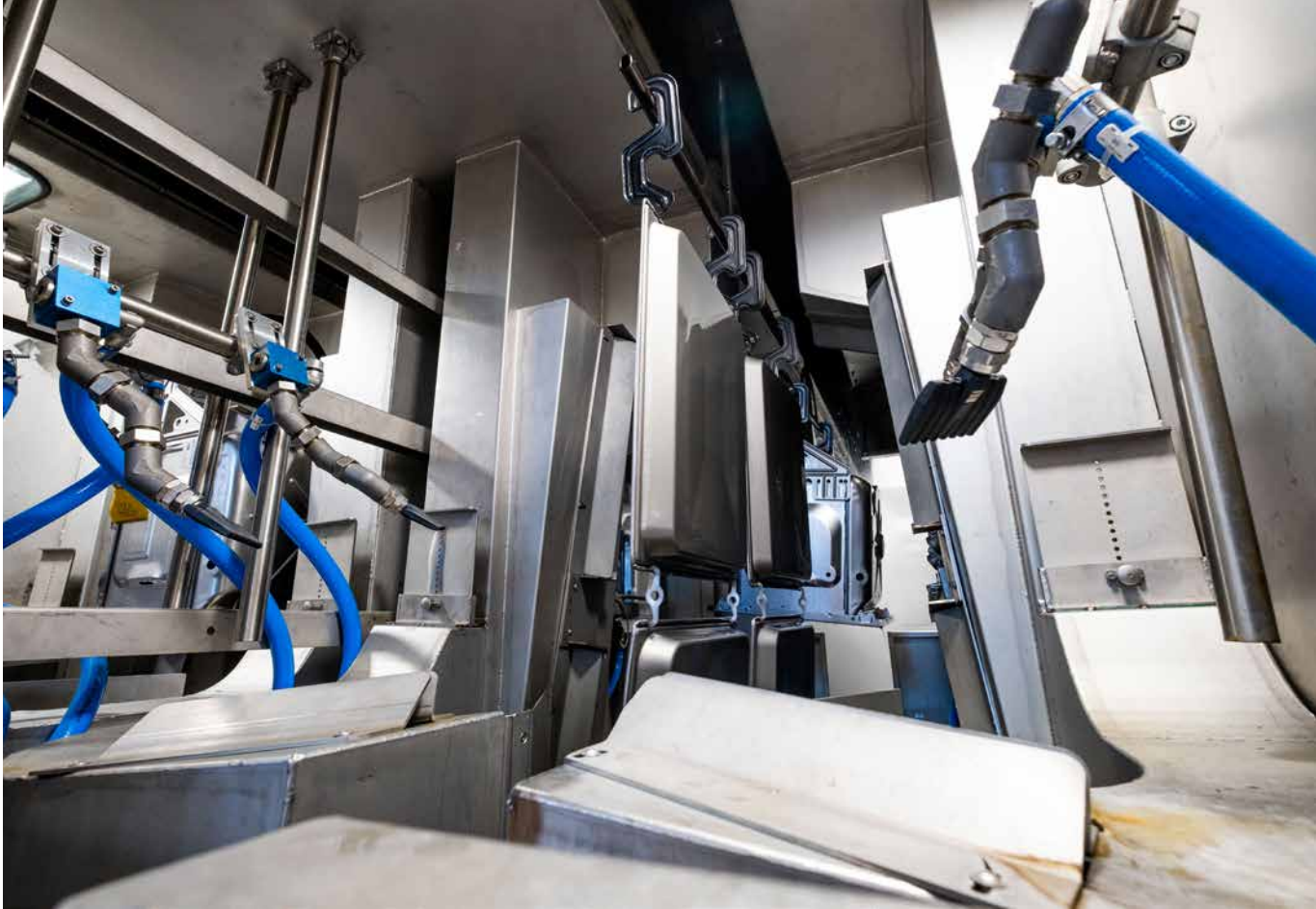
Fest eingestelltes Düsensystem zur Haftwassertrocknung von Kleinteilen
