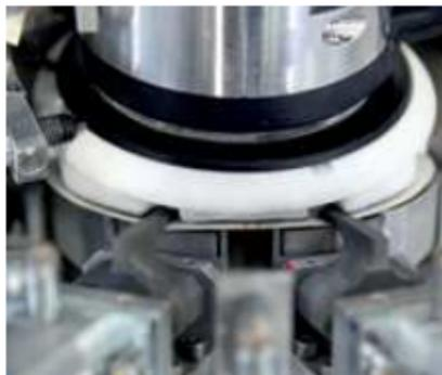
üben. Beim Anlaufen verhindert der Kontaktflansch die Kraftspitze beim Erstkontakt mit der Karosserie. Wichtig ist auch das vollautomatische Wechseln des Schleifmittels an den Wechselstationen. ● dsc
