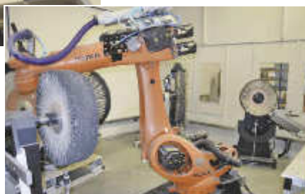
unten: Blick ins Innere der Anlage mit insgesamt sechs Arbeitsstationen und einem Kuka-Industrieroboter mit 150 Kilogramm Traglast
