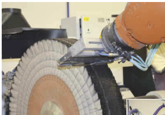
oben: Der Roboter führt das fest eingespannte Bauteil präzise an die jeweilige Polierstation
