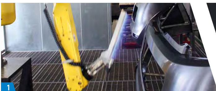
Beflammung mit flexiblem Roboterarm
