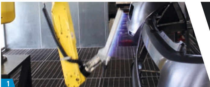
1 Beflammung mit flexiblem Roboterarm
