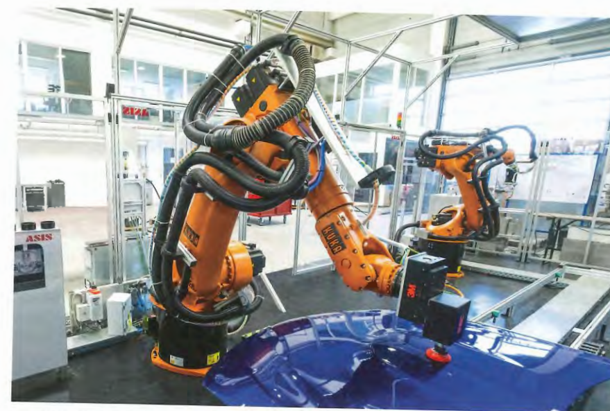
Das Poliermittel wird über die Poliermitteldosierstation exakt dosiert und mit einer Spritzpistole direkt auf die zu polierende Oberfläche aufgesprüht.
