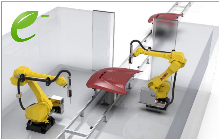
Die Kombination mit einem Industrieroboter ermöglicht die Integration in die Lackierlinie
