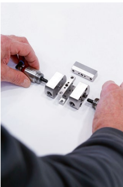
Der modulare Farbwechsler wird im Baukastenprinzip aufgebaut.
