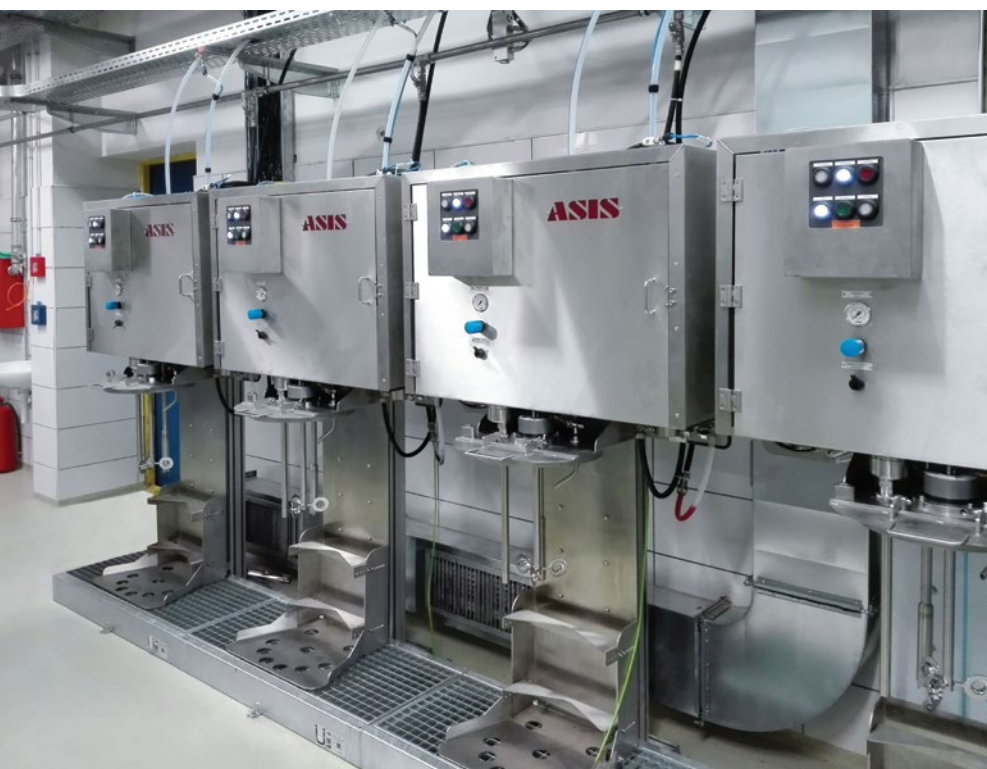
In der Kompaktvariante werden die Gebinde vom Werker auf die Hubplattform gestellt. Das System führt den Hobbock nach oben zum integrierten Rührwerk und den Versorgungsleitungen.
