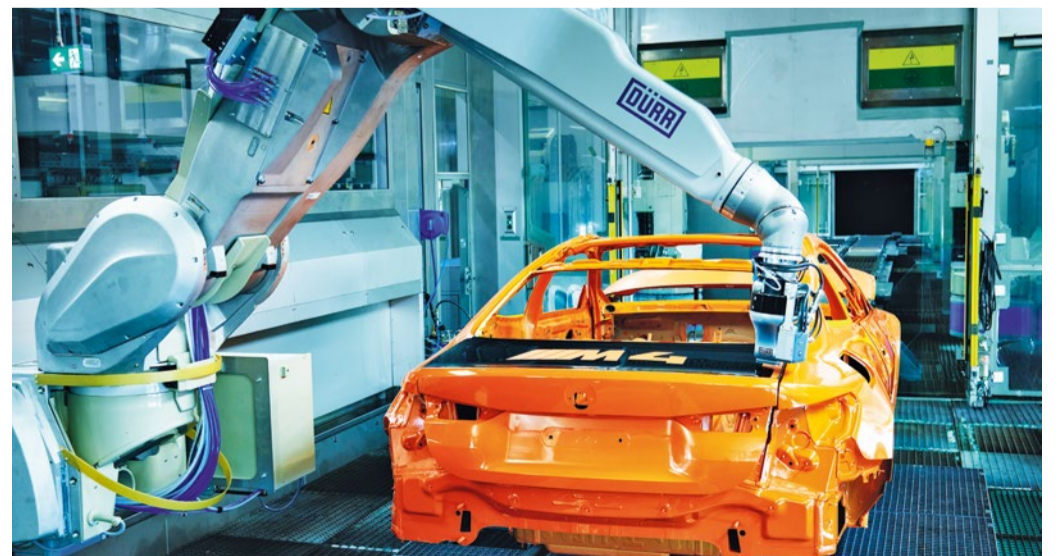
Das BMW Werk Dingolfing hat ein oversprayfreies Lackierverfahren eingeführt. Die Umsetzung erfolgte mit der Weiterentwicklung der „EcoPaintJet“-Technologie von Dürr. Foto: BMW Group
