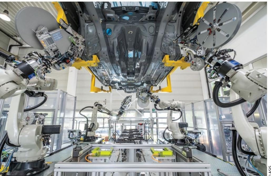
Mit dem Patch-Sealing wird das manuelle Stopfen setzen automatisiert.
