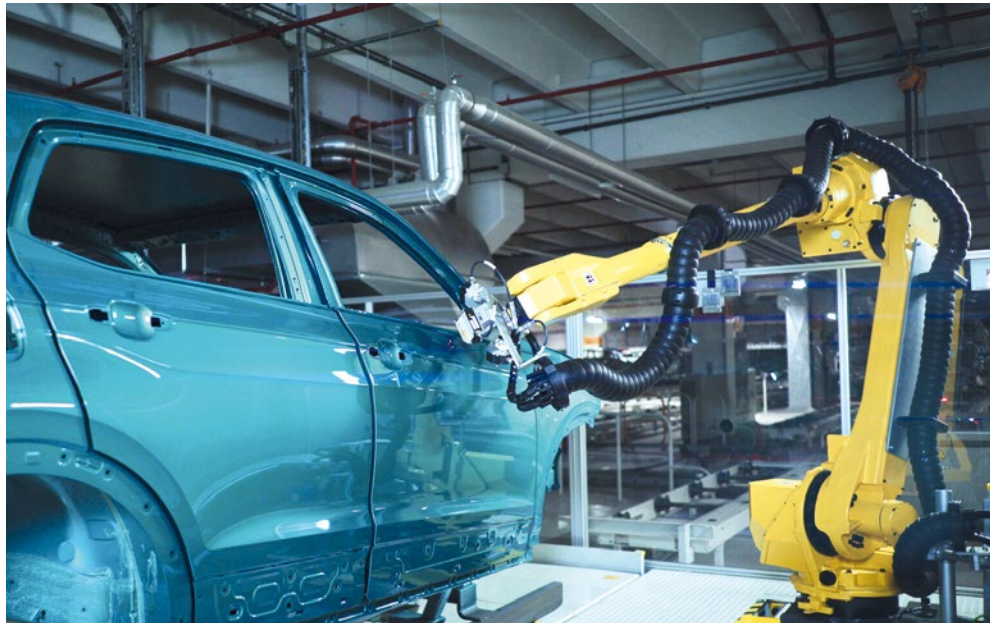
Die Messung mit dem Terahertzsensor erfolgt auf einer etwa 3 x 4 mm großen Fläche. Foto: das-Nano
