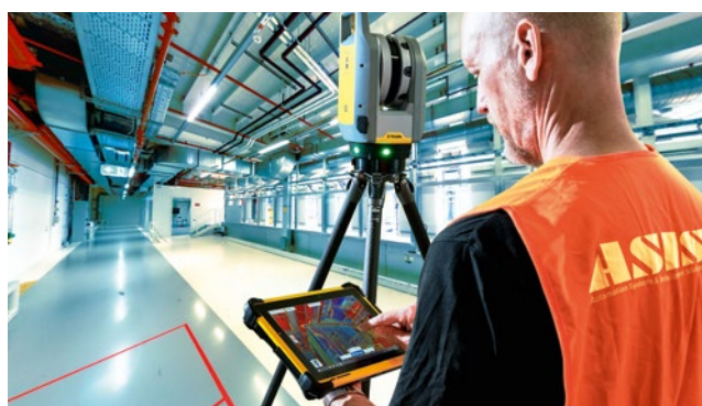
Vor der Anlagenplanung scannt ein Lasersystem die Gegebenheiten extrem genau ein. Fotos: ASIS
