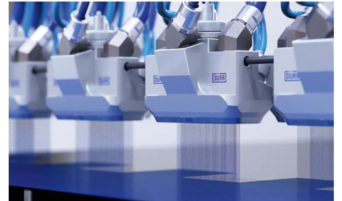
Beim „EcoPaintJet“ verhindert die filigrane Düsenplatte das Entstehen von Overspray. Foto: Dürr
