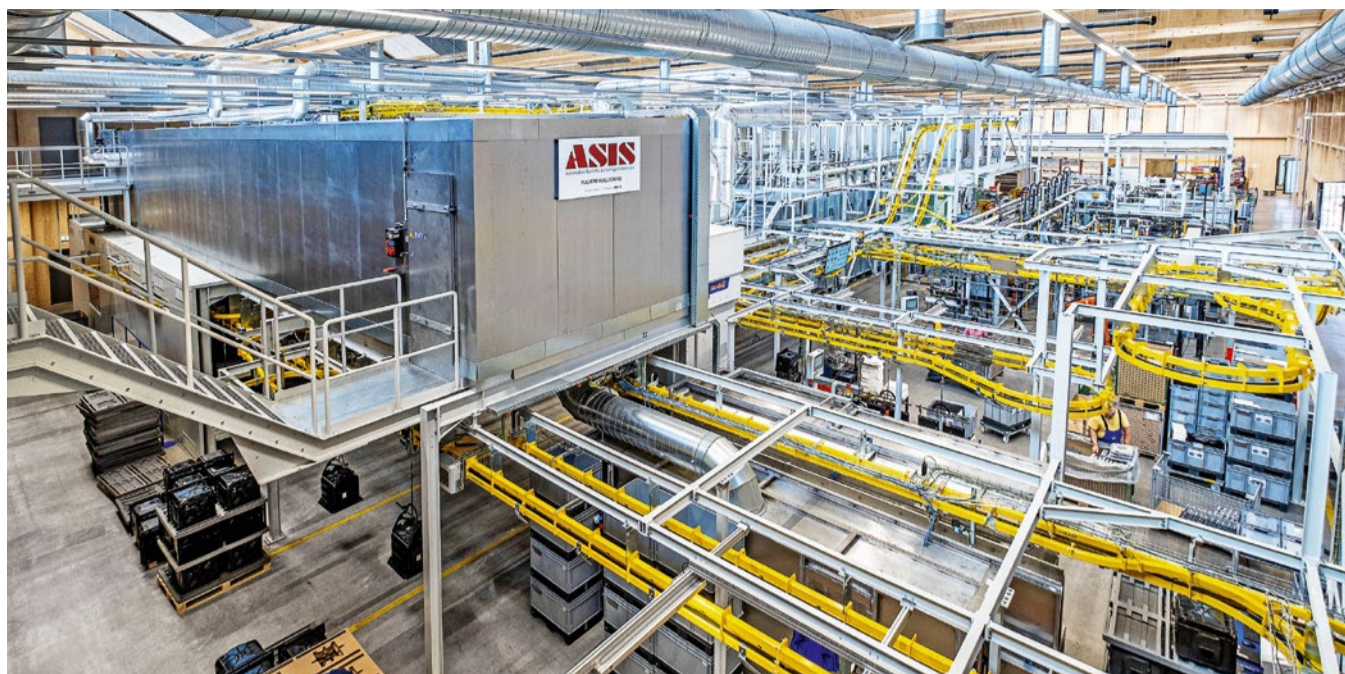
Ein Blick von oben auf die im zweiten Stock installierte Pulver-Emaillieranlage zeigt, wie die Produktion aufgrund knapper Flächen in die Höhe gewachsen ist.
