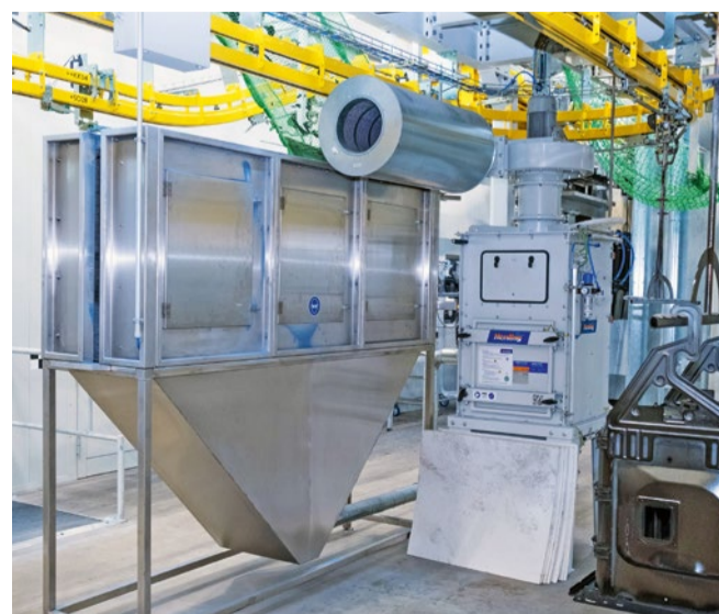
Durch die automatische Reinigung der Gehänge entfallen Sortierfunktionen und einheitliche Gestelle können genutzt werden.
