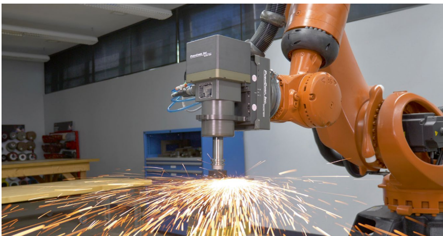
Die passive Kraftregelung eignet sich besonders für einfachere Anwendungen, wie das Glätten von Schweißnähten.
