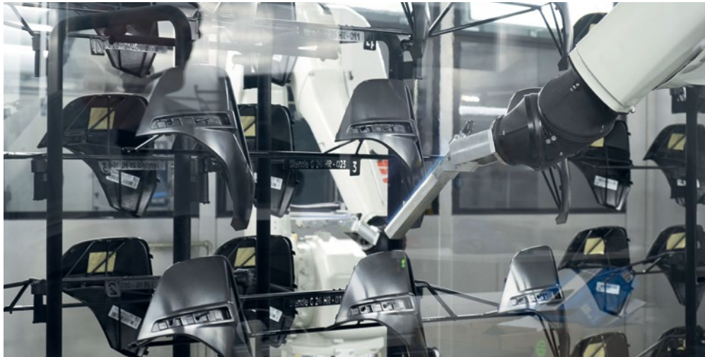
Die Beflammung aktiviert die Oberfläche von Kunststoffteilen und sorgt für eine erhöhte Lackhaftung. Foto: ASIS
