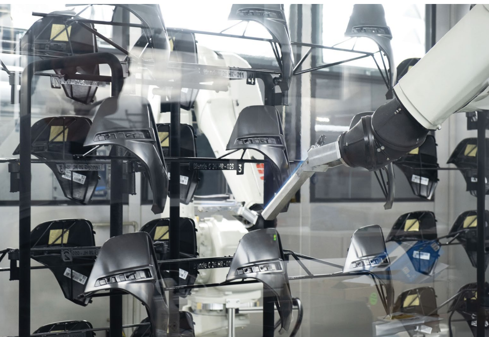
Die Beflammung aktiviert die Oberfläche von Kunststoffteilen und sorgt für eine erhöhte Lackhaftfestigkeit.
