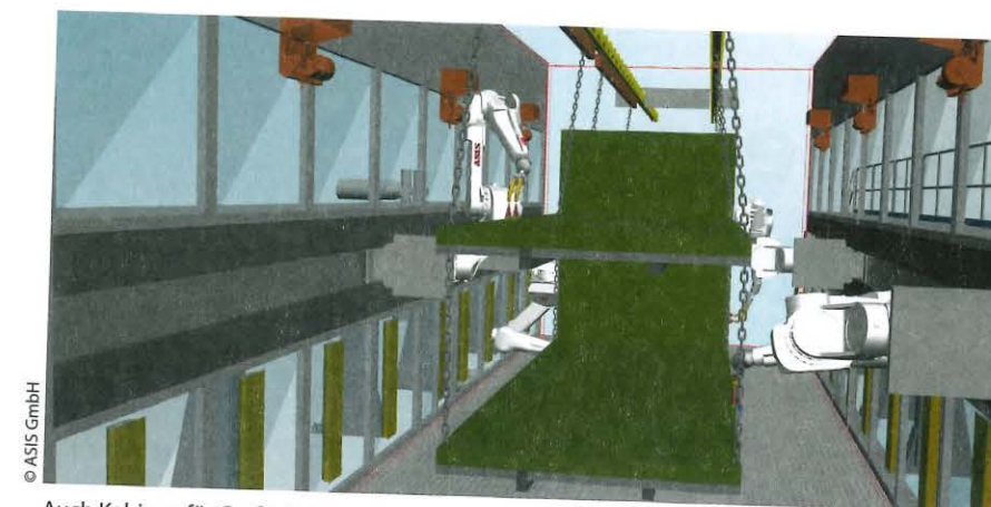
Auch Kabinen für Großteile lassen sich mit Robotern automatisieren – für eine wiederholgenaue Applikation mit konstanten Schichtdicken.
