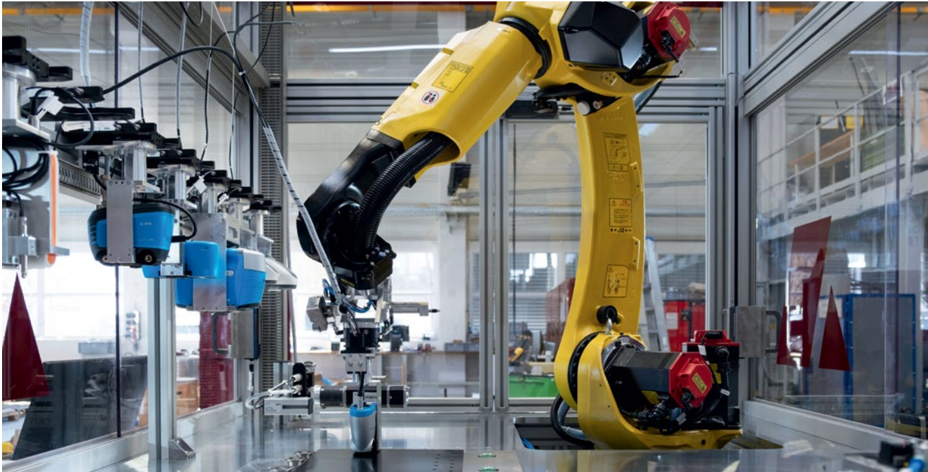
Beim Messsystem kommen kompakte Handmessgeräte zum Einsatz, die der Roboter automatisch wechselt. Foto: ASIS
