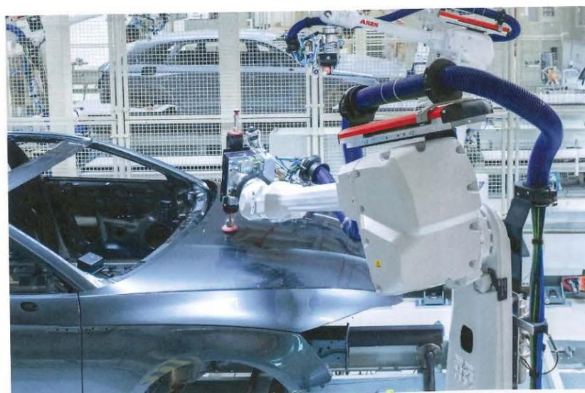
Im automatischen Finish übernehmen Roboter die Reparatur von Defekten in der Serienproduktion.
